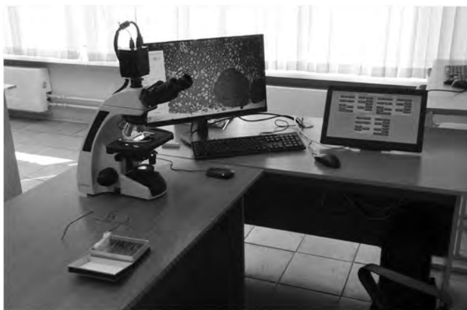
Рис. 2. Организация рабочего места преподавателя в классе цифровой микроскопии. Комплект гистологических препаратов, микроскоп, оснащенный цветной цифровой камерой, монитор, планшет управления источниками видеосигналов
